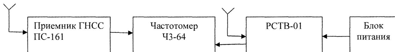
Рисунок 2 Проверка допускаемой абсолютной погрешности синхронизации фронта сигналов 1 с
