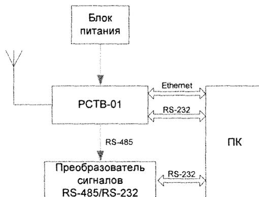
Рисунок 3 Проверка задержки сигналов времени на портах Ethernet, RS-422-1, RS-422-2, RS-232 относительно выходных сигналов «1 с»
