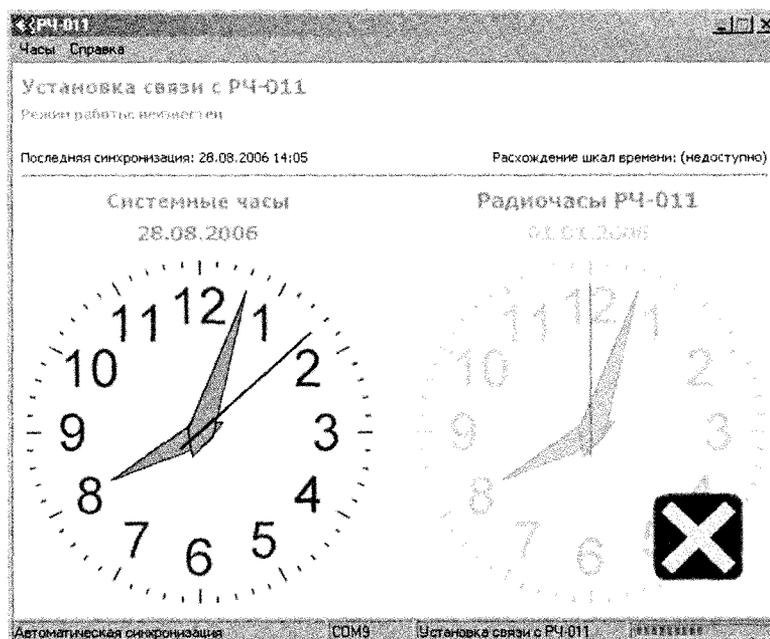
После запуска программа постоянно опрашивает порт подключения, который указан в параметрах подключения. После обнаружения РСТВ-01 выполняется подключение.
