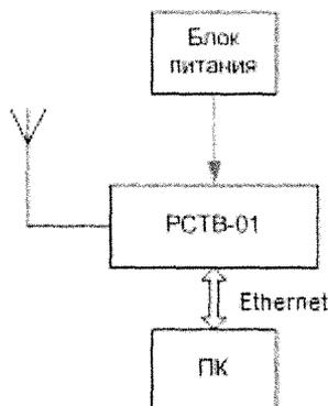
Рисунок 5 Проверка точности хода часов при автономной работе
