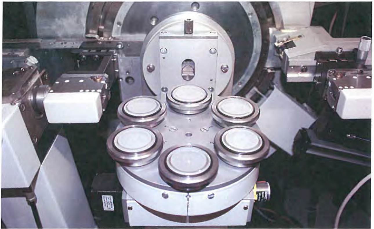
Рисунок Р2. Автосменщик, установленный на вертикальном гониометре аппарата ДРОН-8.
