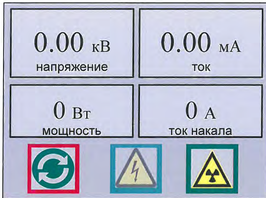
Рисунок С1 - Вид индикационного экрана при включении аппарата.
