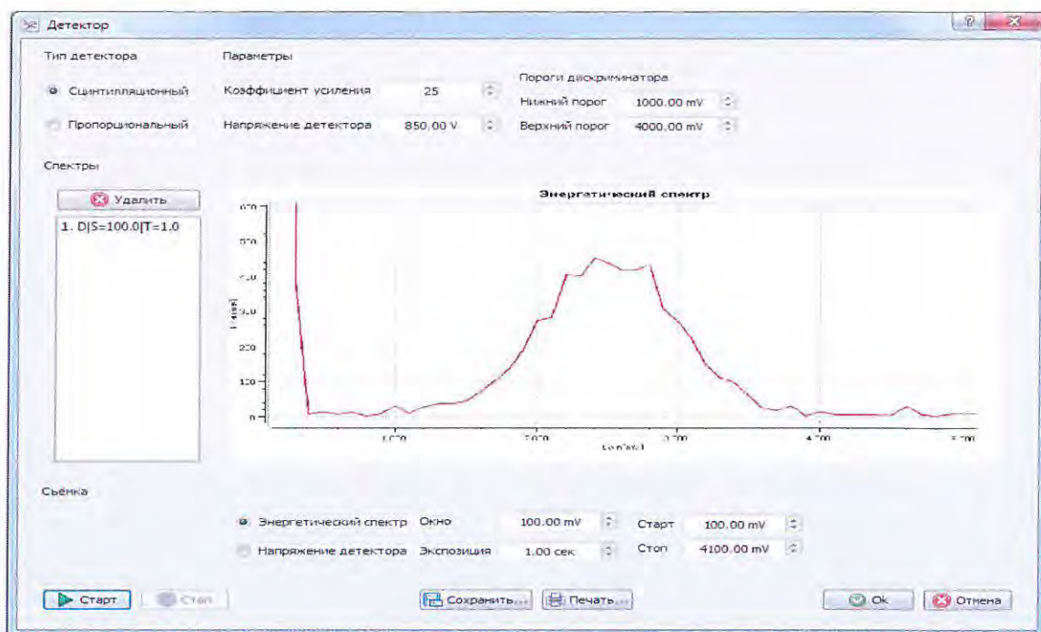
Рисунок 6.12 – Окно «Параметры детектора» в программе DataCol с измеренной кривой амплитудного распределения.
