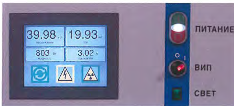
Рисунок С2 - Вид индикационного экрана при наличии связи между средним и верхним уровнем ПО, установленном высоковольтном режиме и закрытой заслонке.
