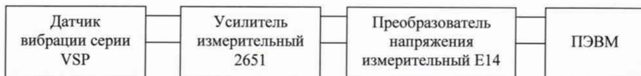
Рисунок 1. Схема подключения датчика вибрации.
