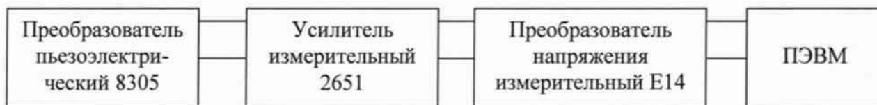
Рисунок 2. Схема подключения преобразователя.
