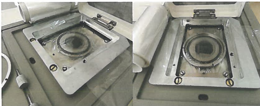
Б) Наложение новой пленки и её фиксация ранее снятым металлическим кольцом.
