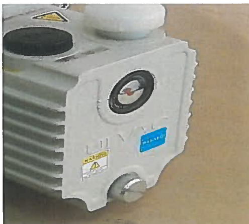
Рисунок 20. Вакуумный насос с вакуумным маслом внутри, вид со стороны смотрового окна.
