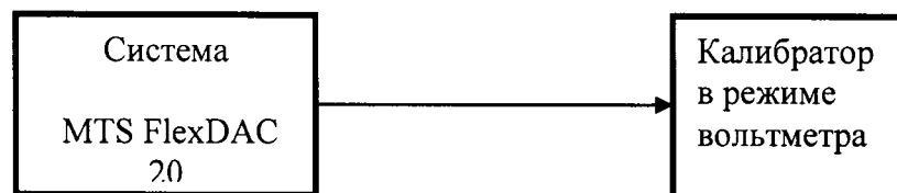
Рисунок 2. Схема проверки основной погрешности ИК аналогового вывода
