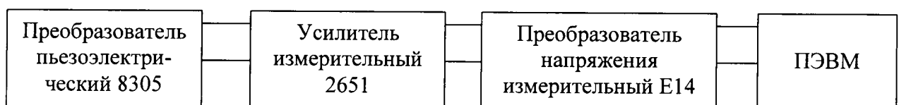
Рисунок 2. Схема подключения преобразователя.
