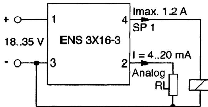
Рисунок 1. Схема подключения внешних устройств к датчику уровня.
