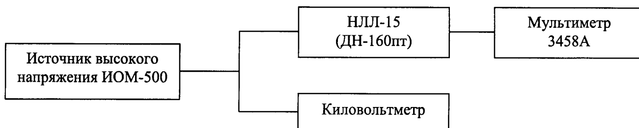
Рисунок 2 – Структурная схема проверки допускаемой основной относительной погрешности измерения напряжения переменного тока
