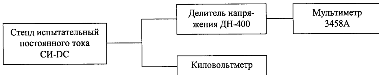
Рисунок 1 – Структурная схема проверки допускаемой основной относительной погрешности измерения напряжения постоянного тока
