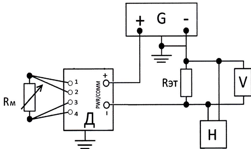
Д – поверяемый преобразователь;
