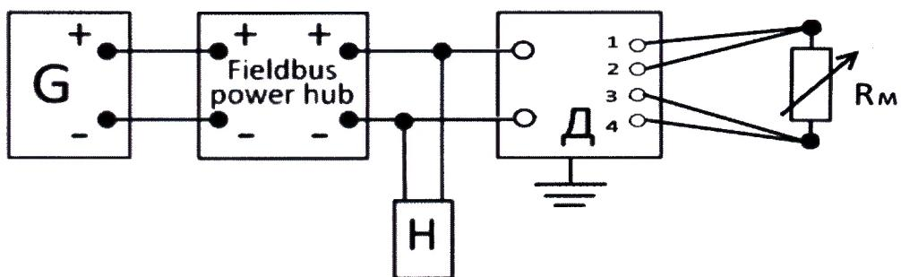
Fieldbus power hub – Распределительная коробка для сегмента шины Foundation Fieldbus;
