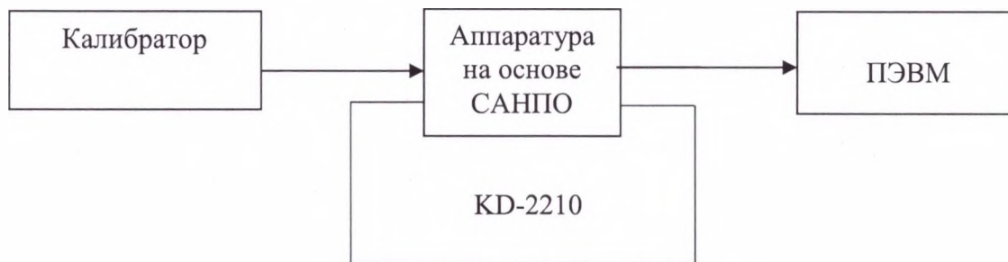
Рисунок 1 – Схема определения приведенной (к диапазону измерения) погрешности измерения (преобразования) среднеквадратического значения силы переменного тока для измерительных каналов №1 и № 2; приведенной (к диапазону измерения) погрешности измерения среднеквадратического значения напряжения переменного тока для измерительных каналов № 1 и № 2
