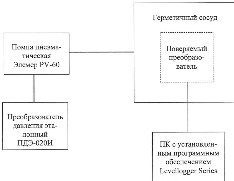
а) Схема определения приведенной (к диапазону измерений) погрешности измерений абсолютного и гидростатического давлений для преобразователей без оптического считывателя USB
