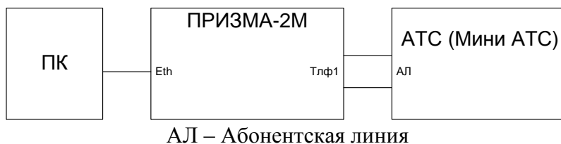
Рисунок 1 – Схема опробования Прибора
