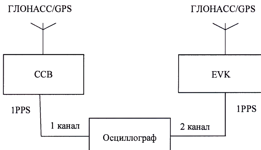
Рисунок 1 – Схема структурная определения абсолютной погрешности привязки переднего фронта выходного сигнала 1PPS (1 Гц) в режиме синхронизации по сигналам ГЛОНАСС/GPS относительно шкалы UTC (US)
