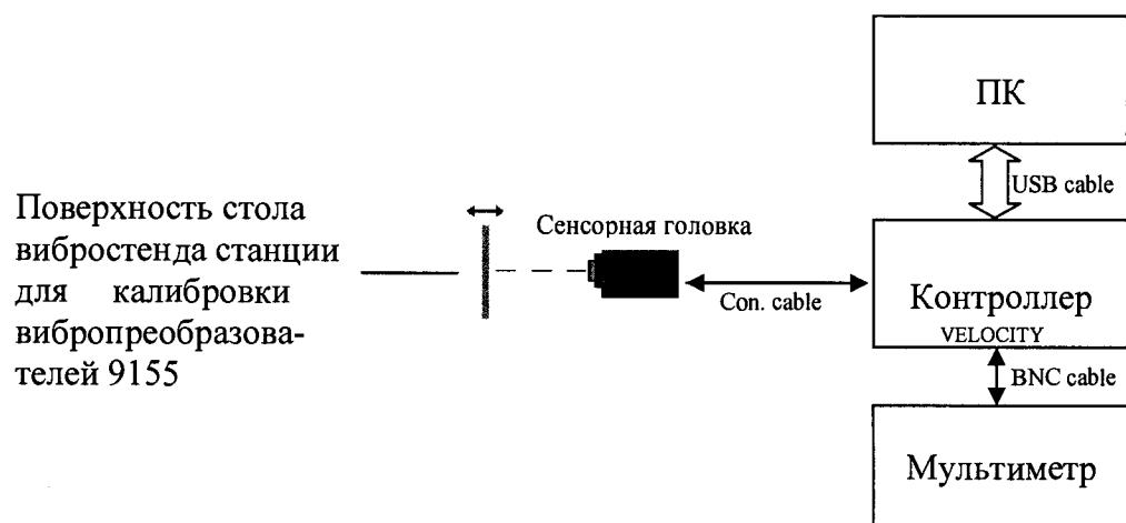
Рисунок 1 - Схема подключения виброметра при опробовании
