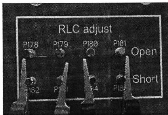
Рисунок 4 – Калибровка измерителя параметров LCR: а) Open-калибровка; б) Short-калибровка.
