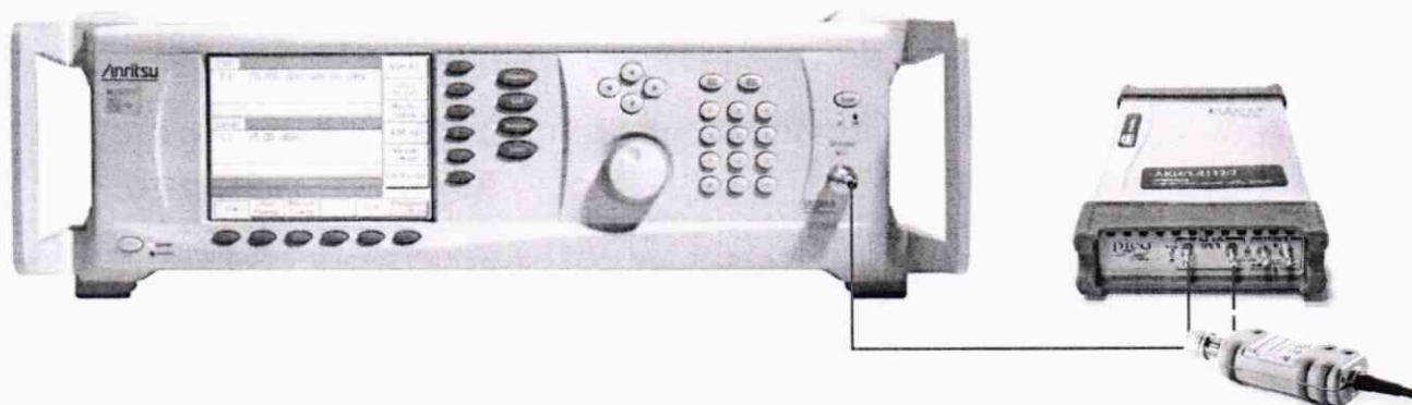
Рисунок 3 – Структурная схема соединения приборов для определения полосы пропускания и времени нарастания переходной характеристики
