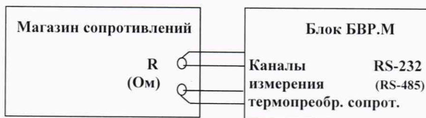
Рисунок 4 – Схема подключения СИ при определении погрешности по каналам измерения сопротивления (термопреобразователи сопротивления)
