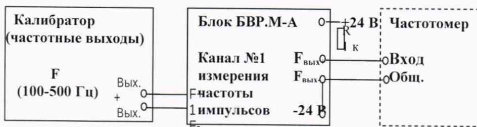
Рисунок 3 – Схема подключения СИ при определении погрешности по дискретному выходу F_{\text{вых}} ( F_{o1} )
