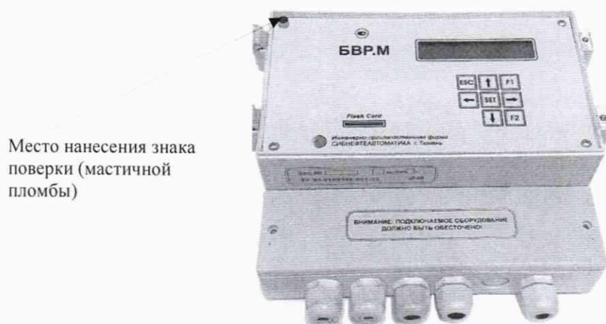
Рисунок Б.1 – Схема нанесения знака поверки на БВР.М-АХХ
