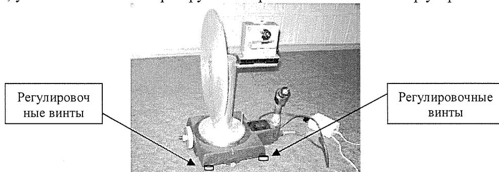
Рисунок 1 - Установка угломерная на основе столов поворотных СТ-9
