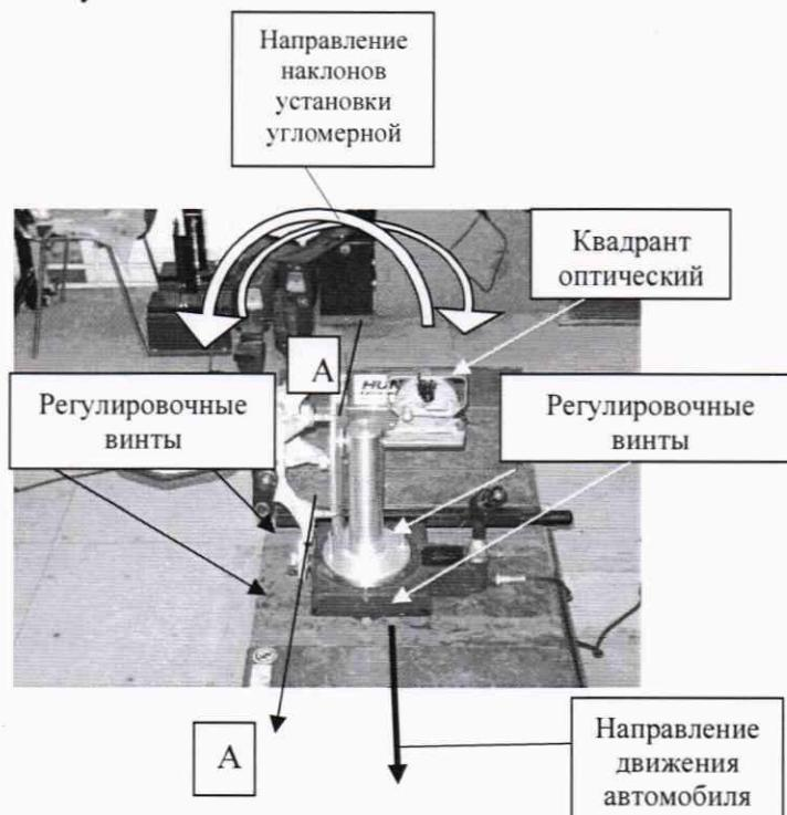
Рисунок 2 - Схема измерений углов раз渲ала колес
