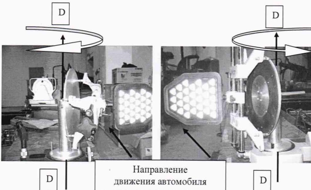
Рисунок 3 - Схема измерений углов индивидуального схождения колес
