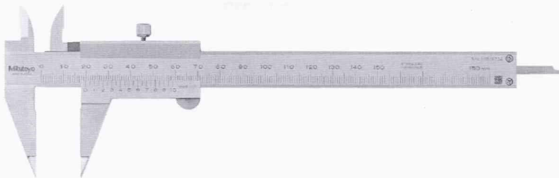
Рисунок 4 - Общий вид штангенциркулей серии 536 модификации нониусный с точечными губками
