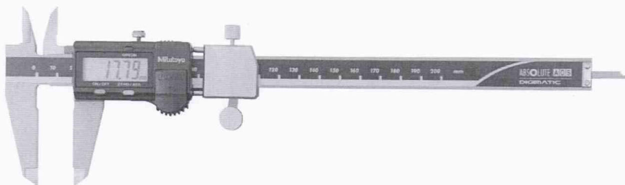
Рисунок 17 - Общий вид штангенциркулей серии 573 модификации ABSOLUTE Digimatic с постоянным измерительным усилием
