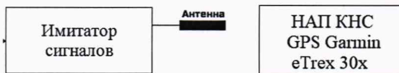
Рисунок 1 – Схема проведения измерений при поверке Аппаратуры
