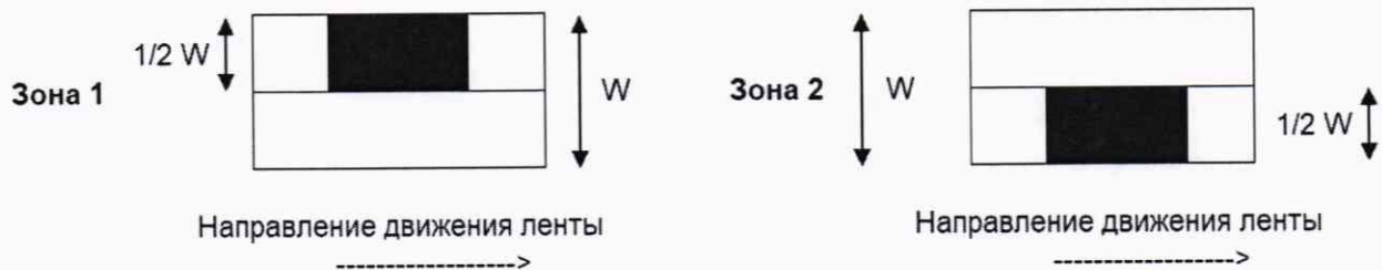
Рисунок 1 — Расположение испытательных нагрузок при оценке погрешности в режиме автоматического действия при нецентрированном положении объектов измерений
