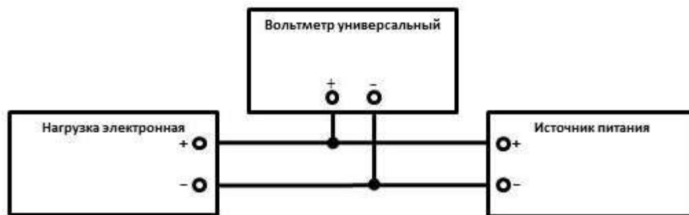
Рисунок 1 – Схема подключения приборов при определении погрешности установки и измерения напряжения
