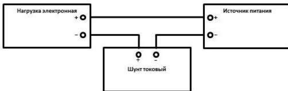
Рисунок 2 – Схема подключения приборов при определении погрешности установки и измерения силы тока
