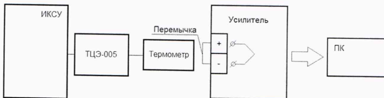
Рисунок 11 – Схема подключений при определении абсолютной погрешности компенсации температуры холодного спая
