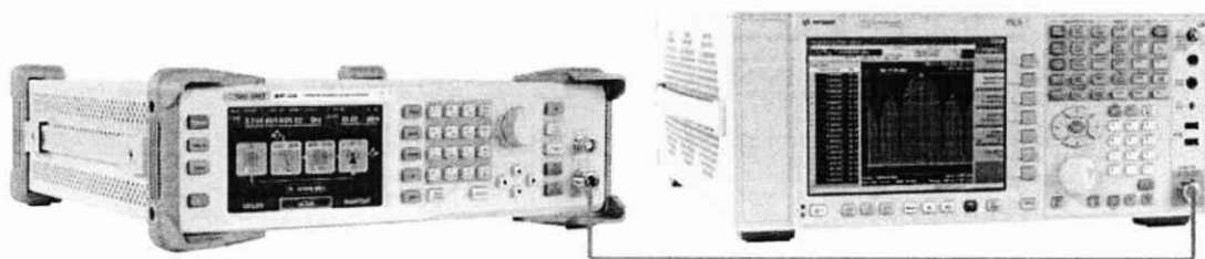
Рисунок 3 – Схема соединения приборов для определения погрешности установки выходного уровня генератора в диапазоне уровней от -50 до -110 дБм и параметров спектра
