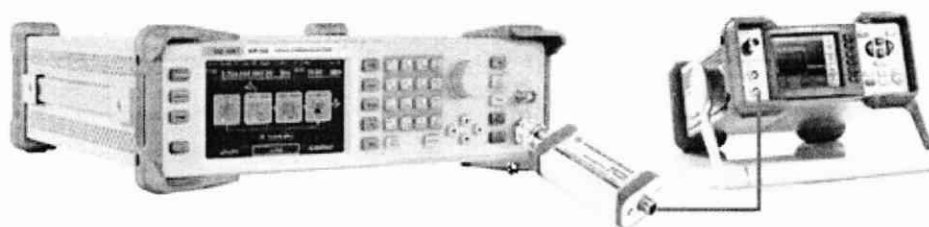
Рисунок 1 – Схема соединения приборов для определения погрешности установки выходного уровня генератора в диапазоне уровней от +20 до -40 дБм
