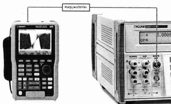
Рисунок 2 – Схема соединения приборов при определении времени нарастания переходной характеристики и определении относительной погрешности частоты внутреннего опорного генератора.
