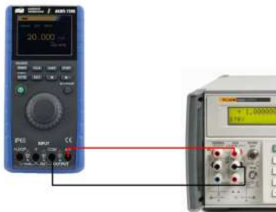
Рисунок 2 – Схема соединения приборов при определении погрешности измерения силы постоянного тока.
