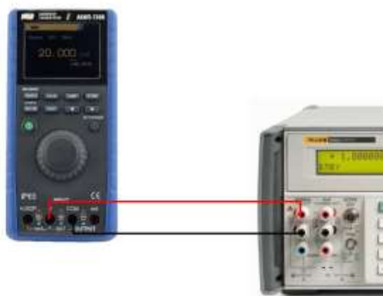
Рисунок 1 – Схема соединения приборов при определении погрешности измерения напряжения постоянного тока.
