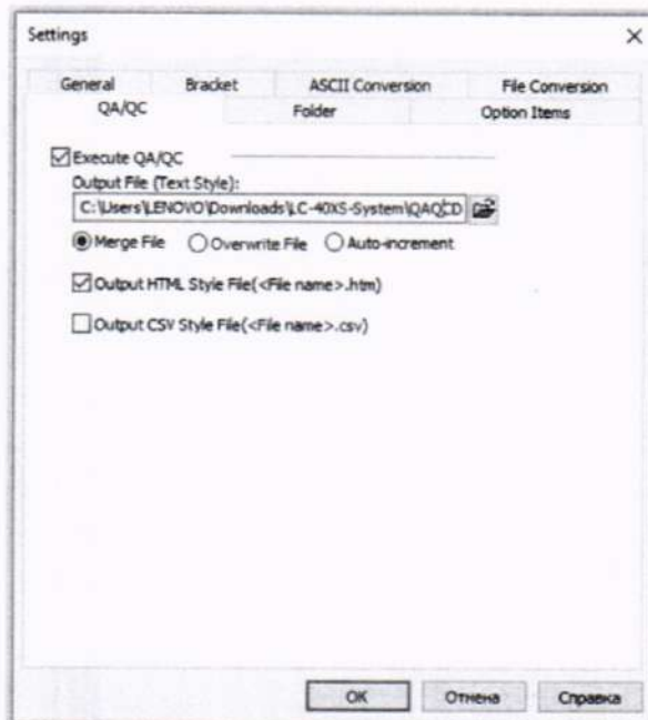
Рисунок 9 - Вывод результатов измерения шума и дрейфа в HTML-файл
