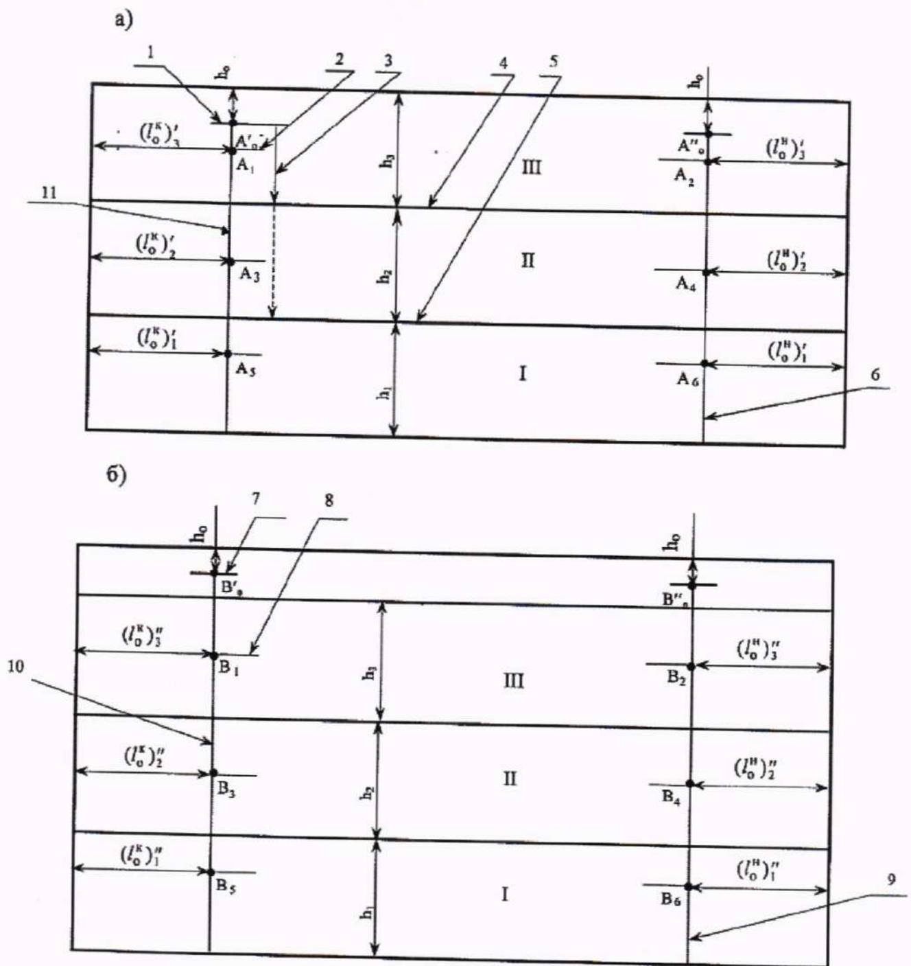
а) – продольная переборка от левого борта судна; б) – продольная переборка в диаметральной плоскости
