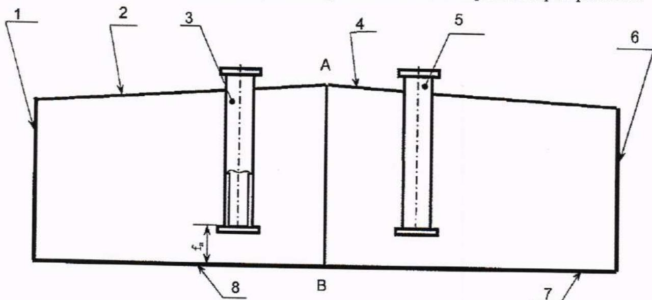
1, 6 – боковые переборки; 2, 4 – палуба судна; 3, 5 – измерительные трубы; 7, 8 – днища танков
