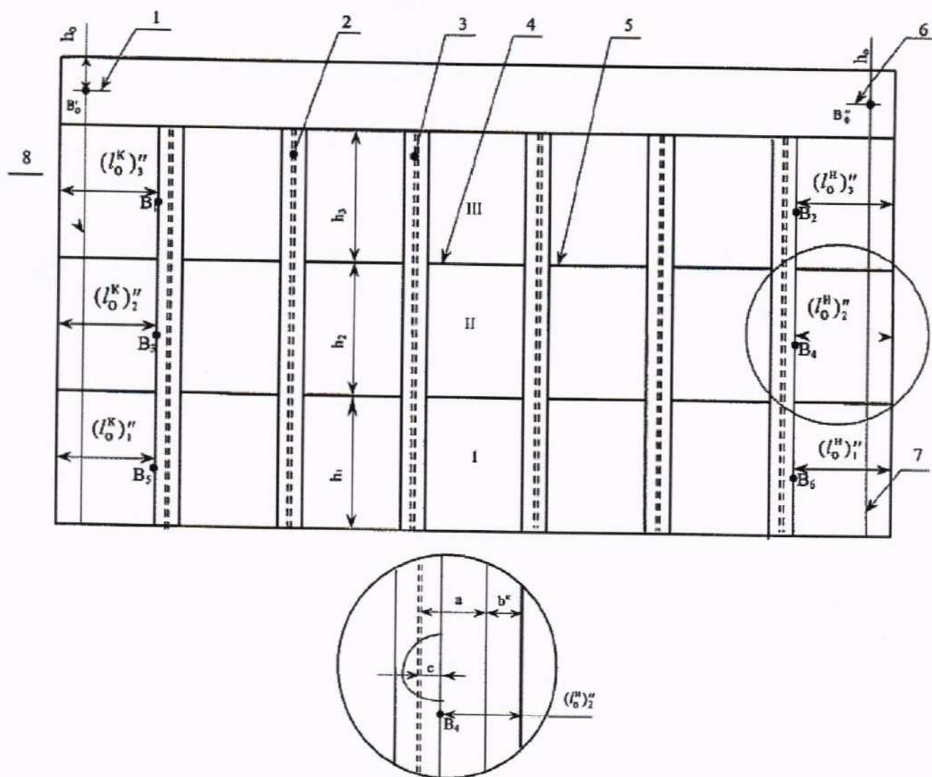
1, 6 – горизонтальные отметки; 2, 3 – рамные стойки (шпангоуты); 4, 5 – сварочные швы;
