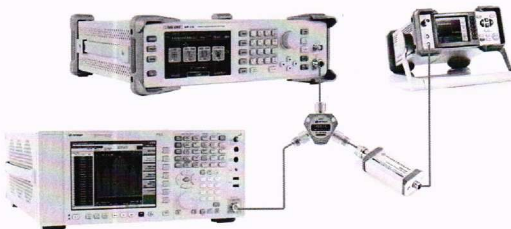
Рисунок 2 – Схема соединения приборов для определения погрешности установки выходного уровня генератора с использованием анализатора спектра N9030A
