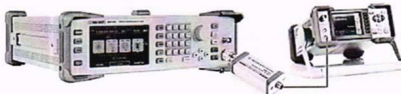
Рисунок 1 – Схема соединения приборов для определения погрешности установки выходного уровня генератора в диапазоне уровней от +20 до -20 дБм
