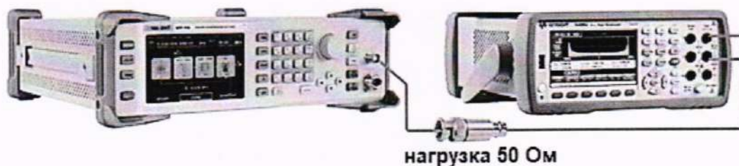
Рисунок 6 – Схема соединения приборов для определения погрешности установки уровня постоянного смещения
