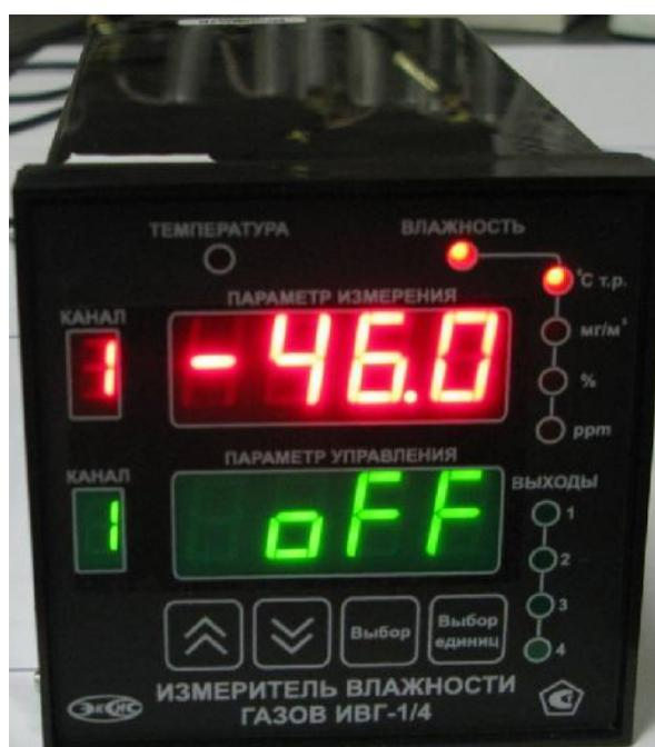
Рисунок 5. Внешний вид модификации ИВГ-1 /X, исполнение ИВГ-1 /X-Щ2
