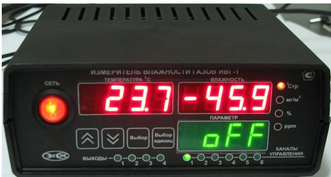
Рисунок 6. Внешний вид модификации ИВГ-1 /X, исполнение ИВГ-1 /X-С
