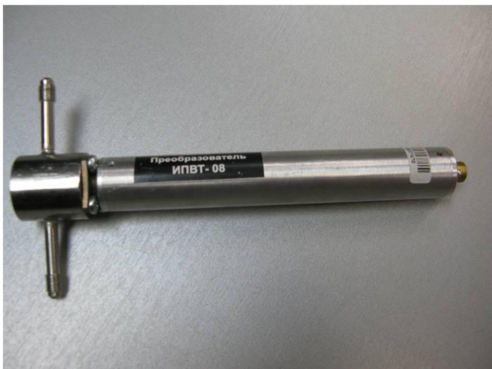
Рисунок 8. Внешний вид измерительного преобразователя ИПВТ-08-01
