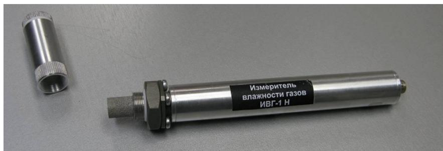
Рисунок 2. Измеритель влажности газов ИВГ-1, исполнение ИВГ-1 Н-03-Д1
