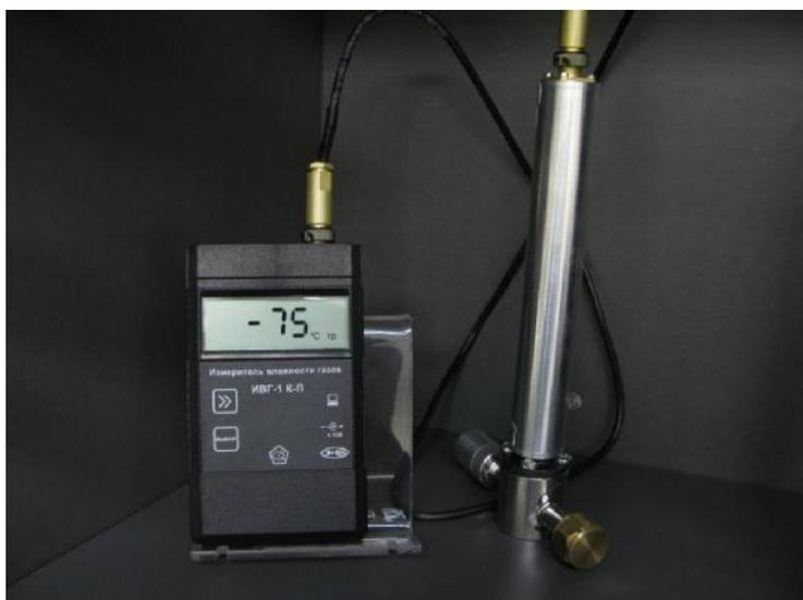
Рисунок 3. Измеритель влажности газов ИВГ-1, модификация ИВГ-1 К-П
