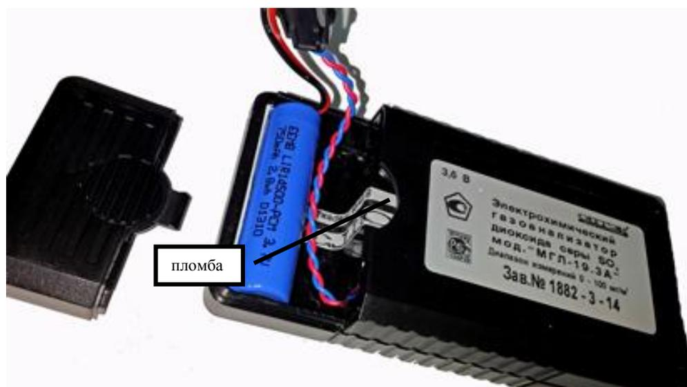
Рисунок 2 – Схема пломбировки газоанализаторов
