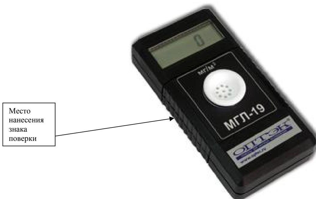
Рисунок 1 – Внешний вид газоанализаторов
