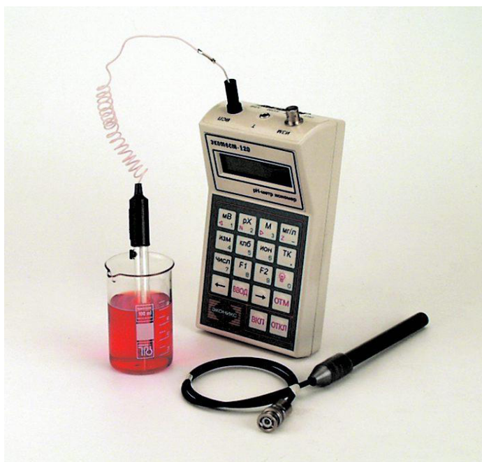
Рисунок 1 – Внешний вид рН-метра – иономера «ЭКОТЕСТ-120»
