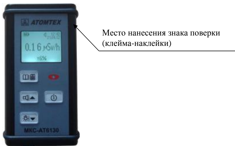
Рисунок 2 – Место нанесения знака поверки (клейма-наклейки)
