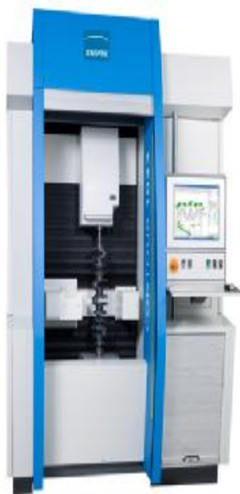
Рис. 1 - Общий вид установок для измерений параметров валов OPTICLINE CONTOUR
