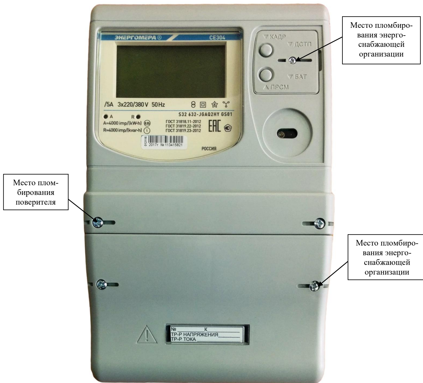
Рисунок 2 – Общий вид счетчика CE 304 S32
