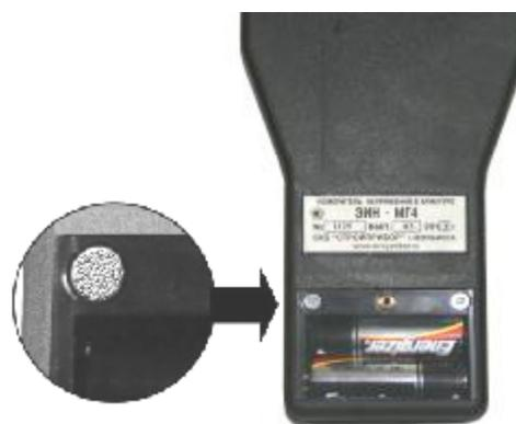
Рисунок 2 – Схема пломбировки от несанкционированного доступа и обозначение места для нанесения отпечатка клейма
