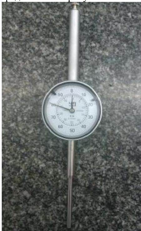
Рисунок 1 – Индикатор часового типа модели ИЧ 50
