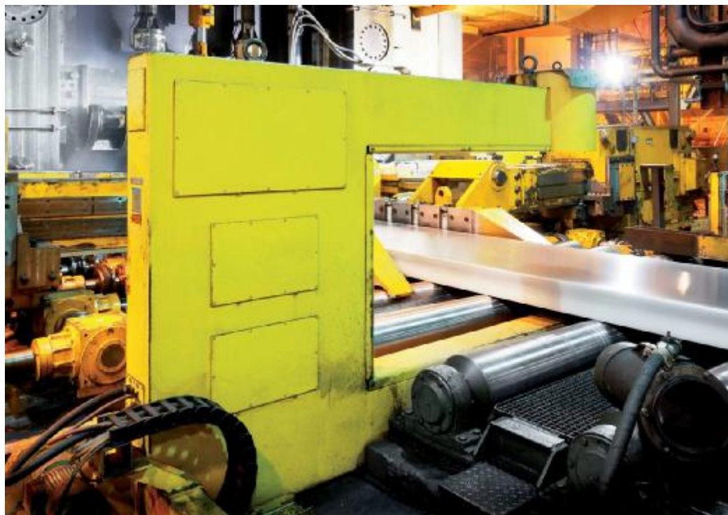
Рисунок 1 – Система измерительная толщины проката рентгеновская MSR с лазерным измерителем длины
