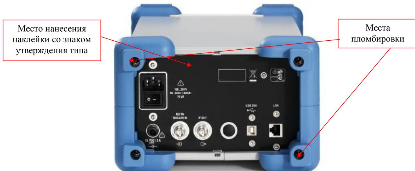
Рисунок 2 - Схема пломбировки от несанкционированного доступа
