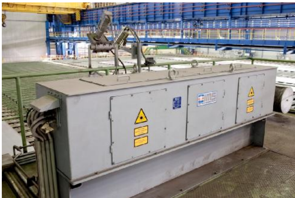
Рисунок 1 - системы измерительной толщины проката лазерной MSO с лазерным измерителем длины
