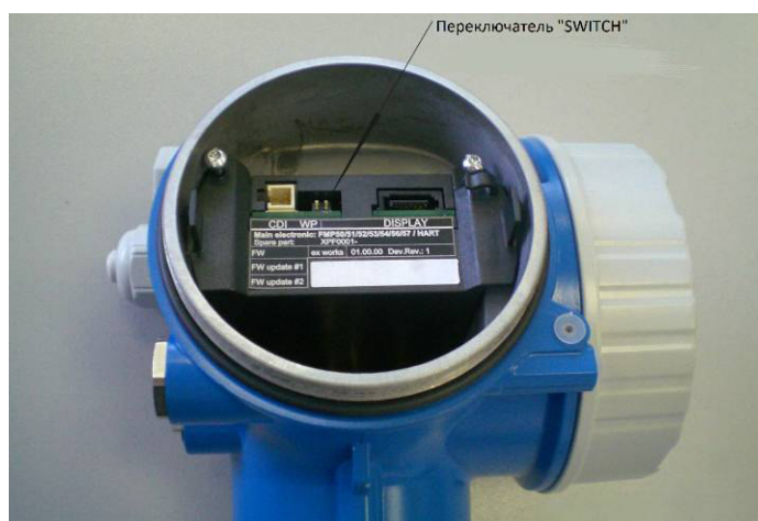
Рисунок 4 - Переключатель «SWITCH» для защиты от несанкционированного доступа к настройкам
