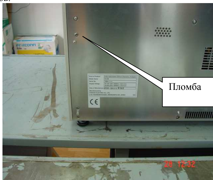
Рисунок 2 – Расположение пломбы. Анализатор биохимический автоматический модели СА-90
