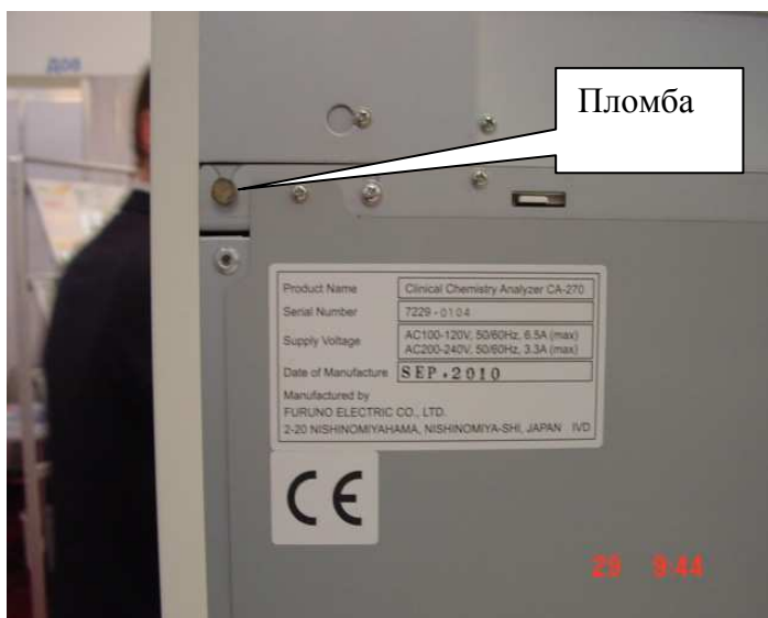
Рисунок 2 – Расположение пломбы. Анализатор биохимический автоматический модели CA-270
