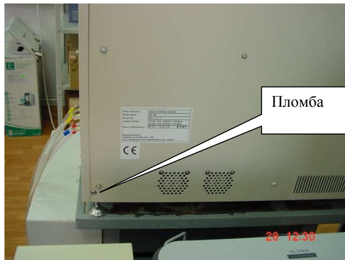
Рисунок 2 – Расположение пломбы. Анализатор биохимический автоматический модели CA-180
