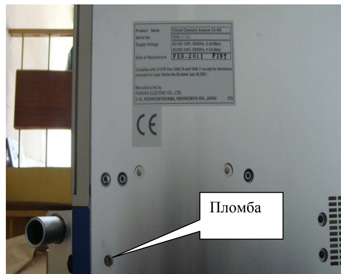
Рисунок 2 – Расположение пломбы. Анализатор биохимический автоматический модели CA-400
