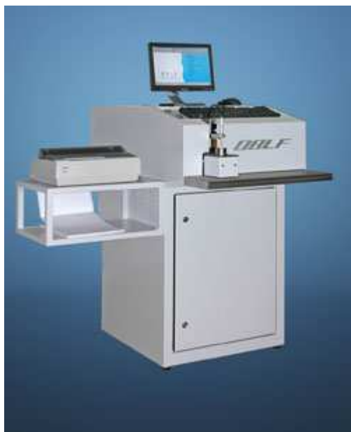
Анализатор автоматический OBLF модель GS1000, GS1000-II
