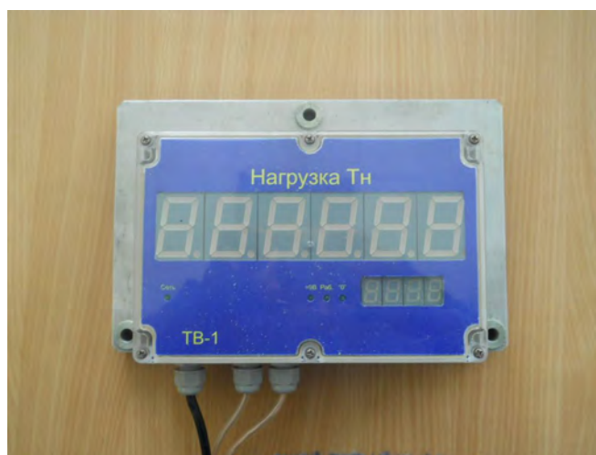
Рисунок 3. Устройство индикации измерительного канала - ТВ-1.
