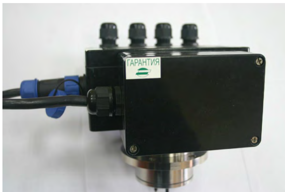
Рисунок 3 - Схема пломбировки корпуса блока СКПДС.БП от несанкционированного доступа
