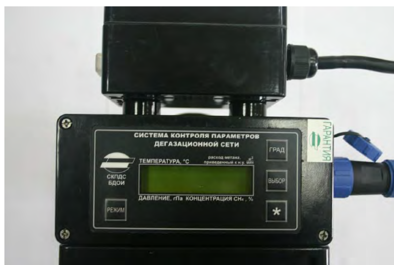
Рисунок 2 - Схема пломбировки корпуса блока СКПДС.БДОИ от несанкционированного доступа
