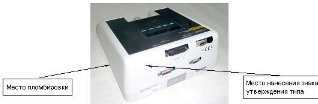
Рисунок 2 – Схема маркировки тестера пульсоксиметрических приборов Index 2XLFE
