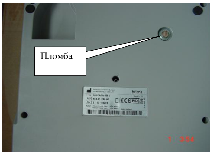
Рисунок 4 – Коагулометр полуавтоматический модели Helena CoaDATA 4001. Расположение пломбы.
