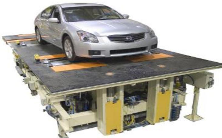
Общий вид стендов измерительных тормозных роликовых RB 200
