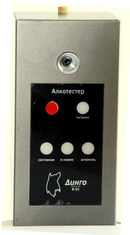
Рисунок 1 – Общий вид анализаторов (лицевая панель).
